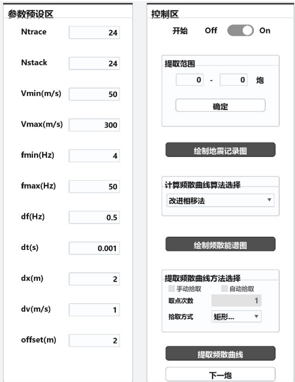
Fig. 2 Function area of dispersion curve extraction module 图2 频散曲线提取模块功能区
